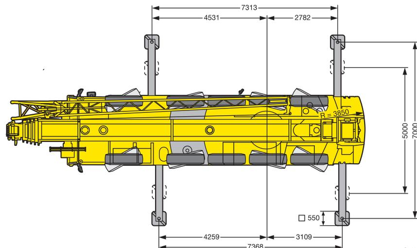
Dieser 5-achsige Taxikran ist für die meisten seiner Aufträge sofort einsatzbereit, da er den Großteil seines Ballastes bereits auf der Straße mitführt. Er verfügt außerdem über einen langen Teleskopausleger und zusätzliche Gittermastverlängerungen für viele Einsatzmöglichkeiten.
