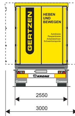
In der Lade- und Transportkalkulation von „normalem“ Ladegut aber mit flexiblen Höhen und Breiten bietet sich diese Art von Trailer an. Zusätzlich verfügt der Krone Profi Liner über ein Planensystem für einen Sichtschutz oder für wetter-sensible Ladungen.
